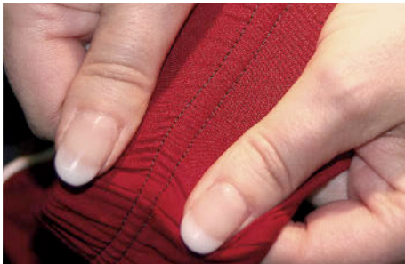
ПРОВЕРКА ШВА: БЛАГОДАРИ ЛЁГКИМ ТЯНУЩИМ ДВИЖЕНИЯМ МОЖНО УВИДЕТЬ ПОВРЕЖДЕНИЕ МАТЕРИАЛА. (РИС. 2)
