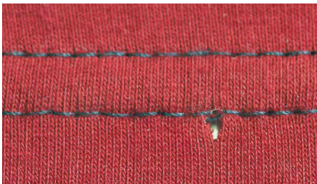
РИС 2. ПОВРЕЖДЕНА ПЕТЛИ - ТЕСТ ПРОДОЛЖАЕТСЯ С МЕНЬШИМ НОМЕРОМ ИГЛОЙ.
